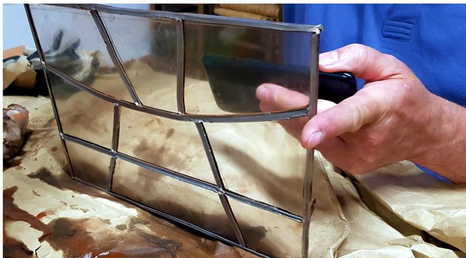
Una vez montados todos los perfiles, se han de soldar con el hilo de estaño todas las uniones de los perfiles. Primero se suelda una cara y después se le da la vuelta y se suelda por la otra. Otra opción es ir soldando a medida que se van montando los perfiles.
