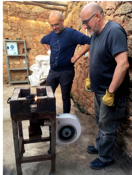
Introducir la varilla de hierro en el fuego e ir controlando su estado. Se irá calentando hasta que la parte introducida en la fragua esté al rojo.
