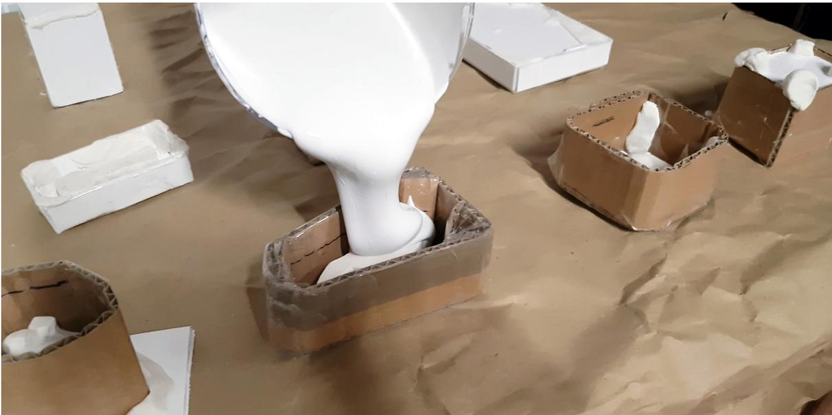
Esperar unas horas hasta que endurezca la silicona (curado completo aproximadamente 24 horas, dependerá de las indicaciones del producto utilizado).
