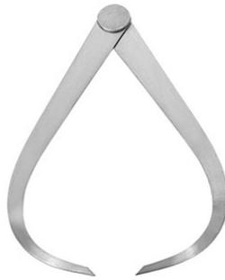
medidor de espesor
